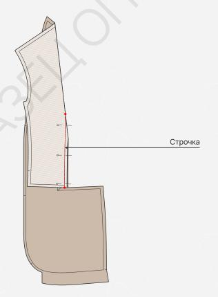
2. Сложить деталь переда лицевой стороной внутрь, уравнивая срезы вытачки, зафиксировать булавками. Стачать вытачку по намеченной линии, убирая булавки, начав строчку у основания вытачки. В начале и в конце строчки обязательно сделать закрепки, не допуская стягивания ткани.
