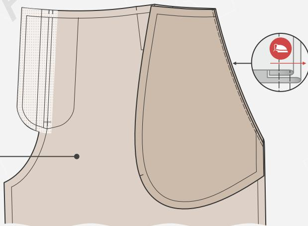
1. Уложить деталь подкладки кармана лицевой стороной к лицевой стороне передней половинки брюк, совмещая срезы входа в карман. Зафиксировать булавками. Обтачать вход в карман шириной шва 7 мм, убирая булавки.
